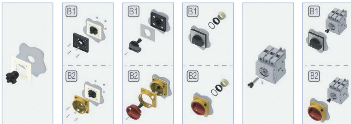
**Установка крышки и замка:** при необходимости установите защитные крышки винтов и замок блокировки рукоятки, как показано на схеме ниже.
